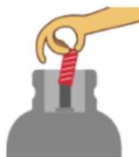
Para retirar el sello de seguridad de un cilindro de gas, no se deben usar elementos cortantes como cuchillos o tijeras, ya que podrían dañar la válvula.
